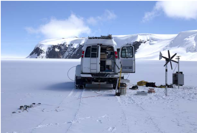
Uppsetning á nýju GPS-tæki Veðurstofunnar í Grímsvötnum, Benedikt Ófeigsson í lokafrágangi á köplum. Ljósmynd/ Photo : Hrafnhildur Hannesdóttir, 5. júní 2020. – Installation of the new GPS instrument in Grímsvötn, Benedikt Ófeigsson connecting the cables.
