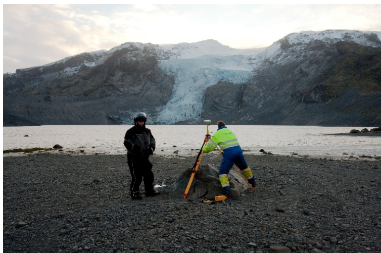
Ármanngi Ingi Sigurðsson og Sveinn Svavarsson setja upp mælitæki á fastmerki við Gígjökul 27. nóvember 2009. Þetta er að líkindum síðasta mynd sem til er af merkinu því að það hvarf í hlaupinu 14. apríl 2010. – The last image of the benchmark for front variations measurements at Gígjökull on 27 November 2009. The boulder was lost in the jökulhlaup of 14 April 2010. Ljóssm./Photo: Páll Bjarnason.
